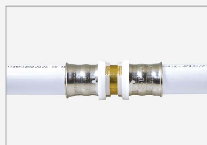
Idom préselve és tesztelve 1 és 4,5 BAR nyomással - NEM szivárog
