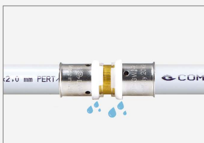
Idom préselés nélkül tesztelve 1 és 4,5 BAR nyomással - Szivárog
